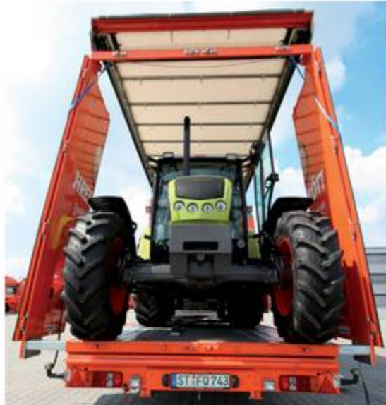
Platz da: Der Spezialaufbau ermöglicht Ladehöhen bis 3,40 m und Ladebreiten bis 3,20 Meter.
