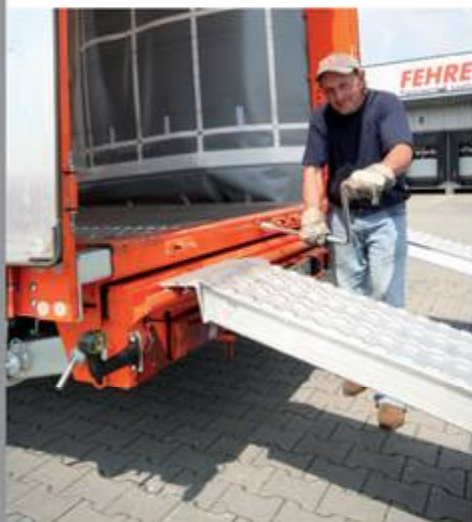
Den Dreh raus: Das Heckportal lässt sich per Kurbel ausfahren.
